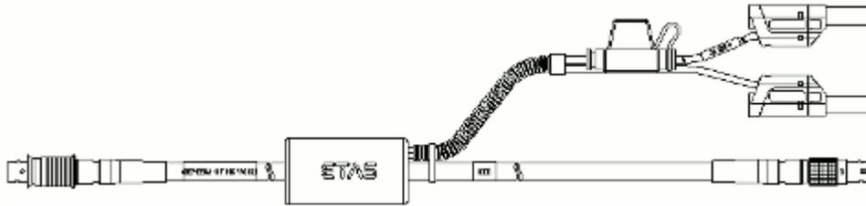
Câble de connexion Ethernet et d'alimentation, Lemo 1B FGF – Lemo 1B FGL – Fiches banane (8mc-8fc+2mc), 3 m
