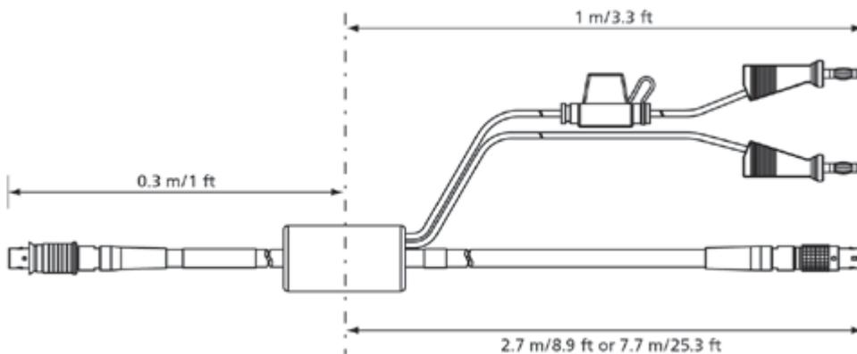
Câble de connexion Ethernet et d'alimentation, Lemo 1B FGF – Lemo 1B FGL – Fiches banane de sécurité (8mc-8fc+2mc), 3 m
