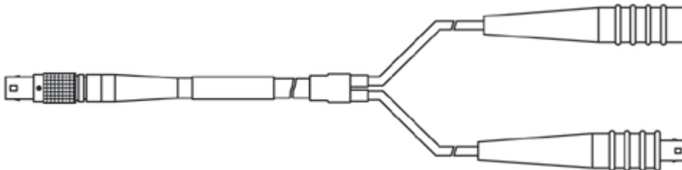
CAN 인터페이스 케이블, OBDII J1962 - Lemo 1B FGC (16mc-8mc), 2m5      2.50 m      CBAC150-2m5      F-00K-104-159
