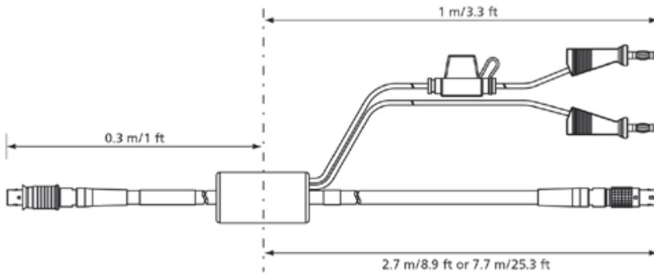
Câble de connexion Ethernet et d'alimentation,
