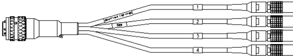
電圧プローブ、840V絶縁、4チャンネル、840Vレンジ, Souriau 8ST12-35 - 4x オープンワイヤ (22mc - 4x 2c), 4 x 1m CBN400.1-1 F-00K-107-227
